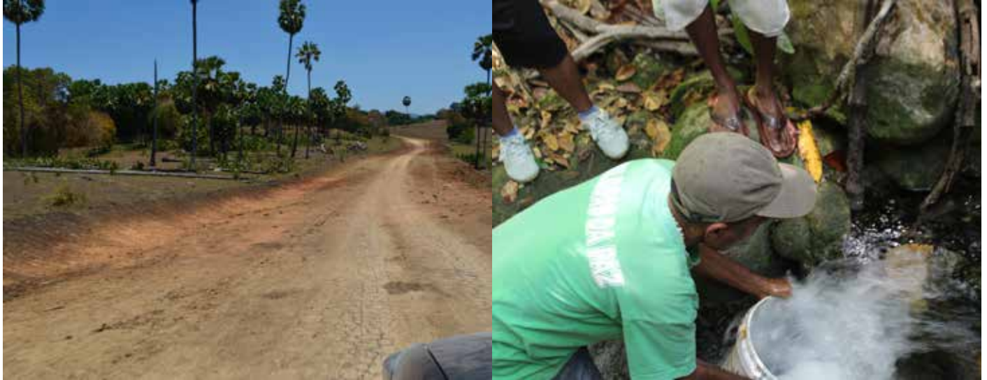
Da esquerda para a direita: Acesso rodoviário recém-construído para a proposta área de Nova Beaçó & Nova Knuá's; Técnico da SAS a medir manualmente da taxa de fluxo da água na nascente de Ulu-Ira
