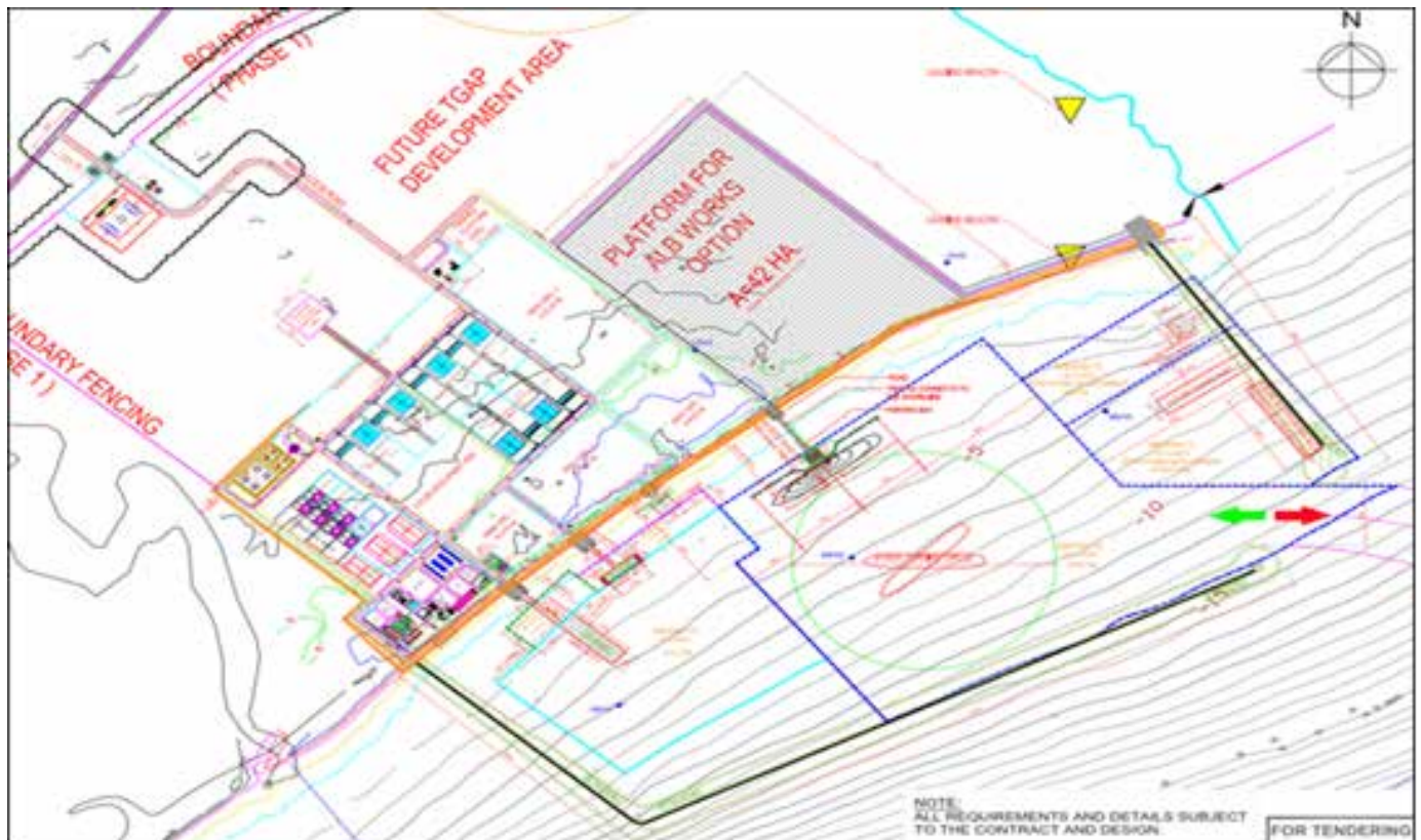
Revisão do plano geral da SSB, com uma ponte-cais adicional para líquidos e dragagem a -14m ACD
