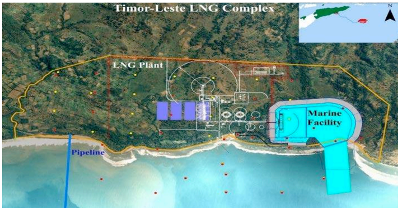
Figura 4-15: Fábrica de GNL, Instalação Marítima e Ponto de Chegada do Gasoduto a Terra (Secção Onshore)
