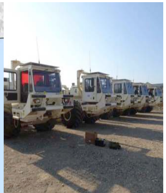
Figura 2-7: Resultados Preliminares do Levantamento Sísmico Fafulu 2D (esquerda); Camiões Vibradores ( Vibrotrucks ) (direita)
