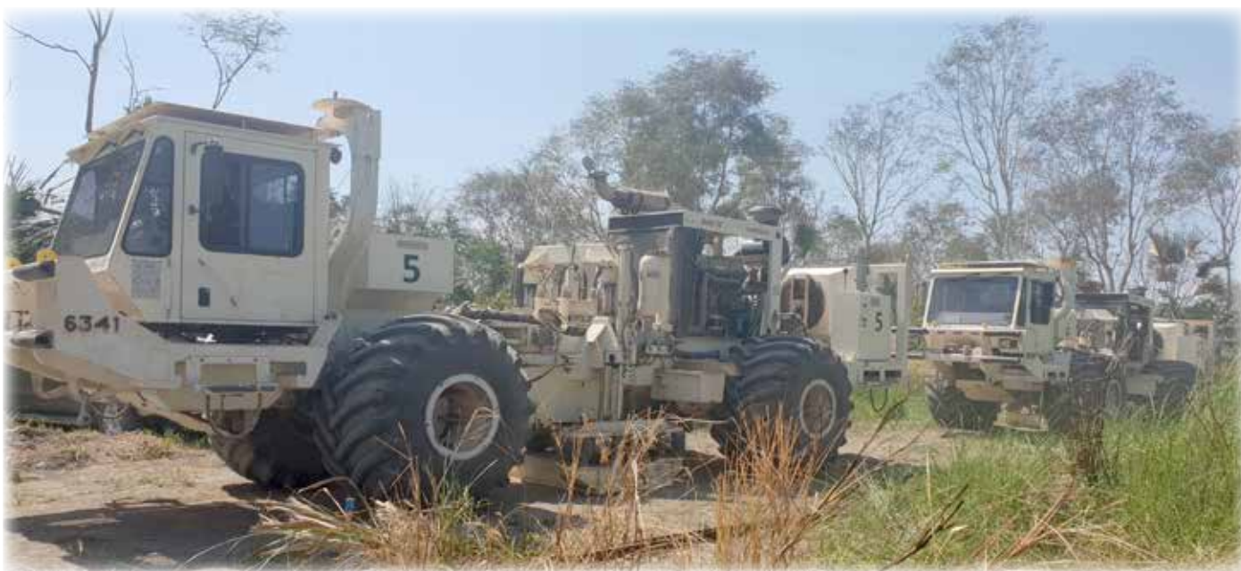
Figura 2-6: Camiões vibradores ( vibroseis trucks ) durante aquisição sísmica 2D no Bloco C
