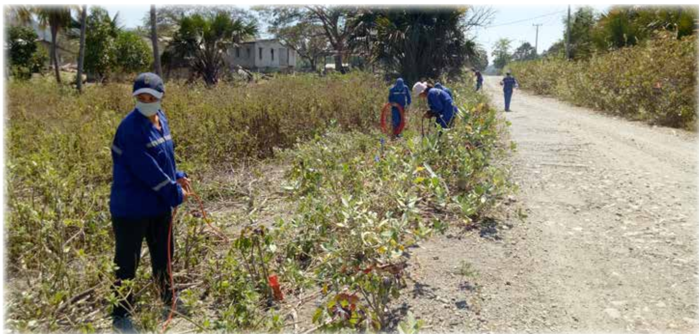
Figura 3-4: Equipa da TGSS a instalar os Geófonos Sísmicos
