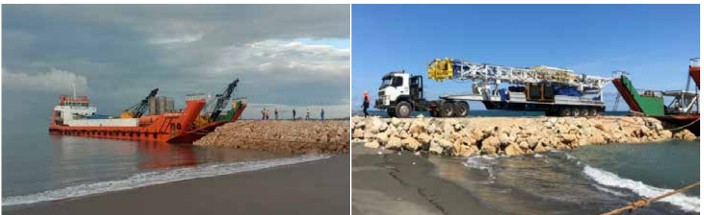
Figura 2-14: Ancoragem do LCT Maritindo Perkasa 2 no cais do porto do Suai (esquerda); operação de descarga do mastro da sonda de perfuração (direita)
